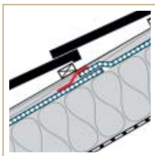
SOLITEX PLUS na pásovině pro uložení bez záklopu.
