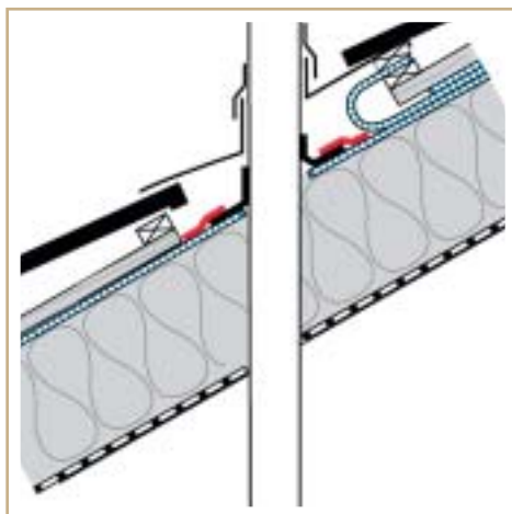
Napojení prostupu. Vytvořte žlábek z fólie
