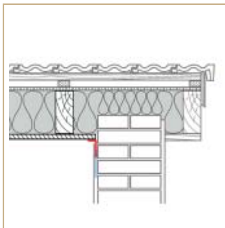
napojení na štítovou desku, která má být omítnuta, pomocí CONTEGA PV
