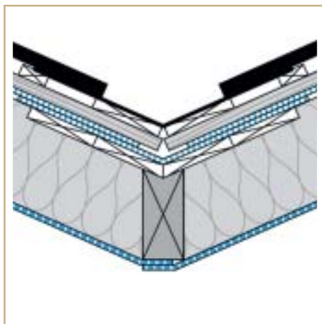
Pásky střešní izolace položit na pásovinu uloženou v úžlabí.
