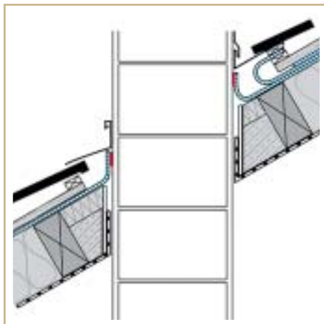
Napojení komína. Vytvořte žlábek z fólie
