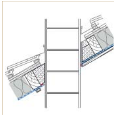
Napojení na omítnutý komín pomocí ORCON F nebo ECO COLL.
